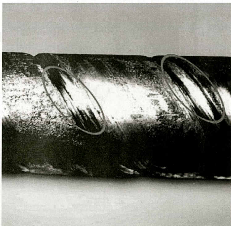
Rysunek 10. Poważne zużycie trzpienia śruby wywołane silnym tarciem spowodowane zanieczyszczeniami, np. opiłkami żelaza - dotyczy pkt. 2.1.8 oraz 2.1.9
